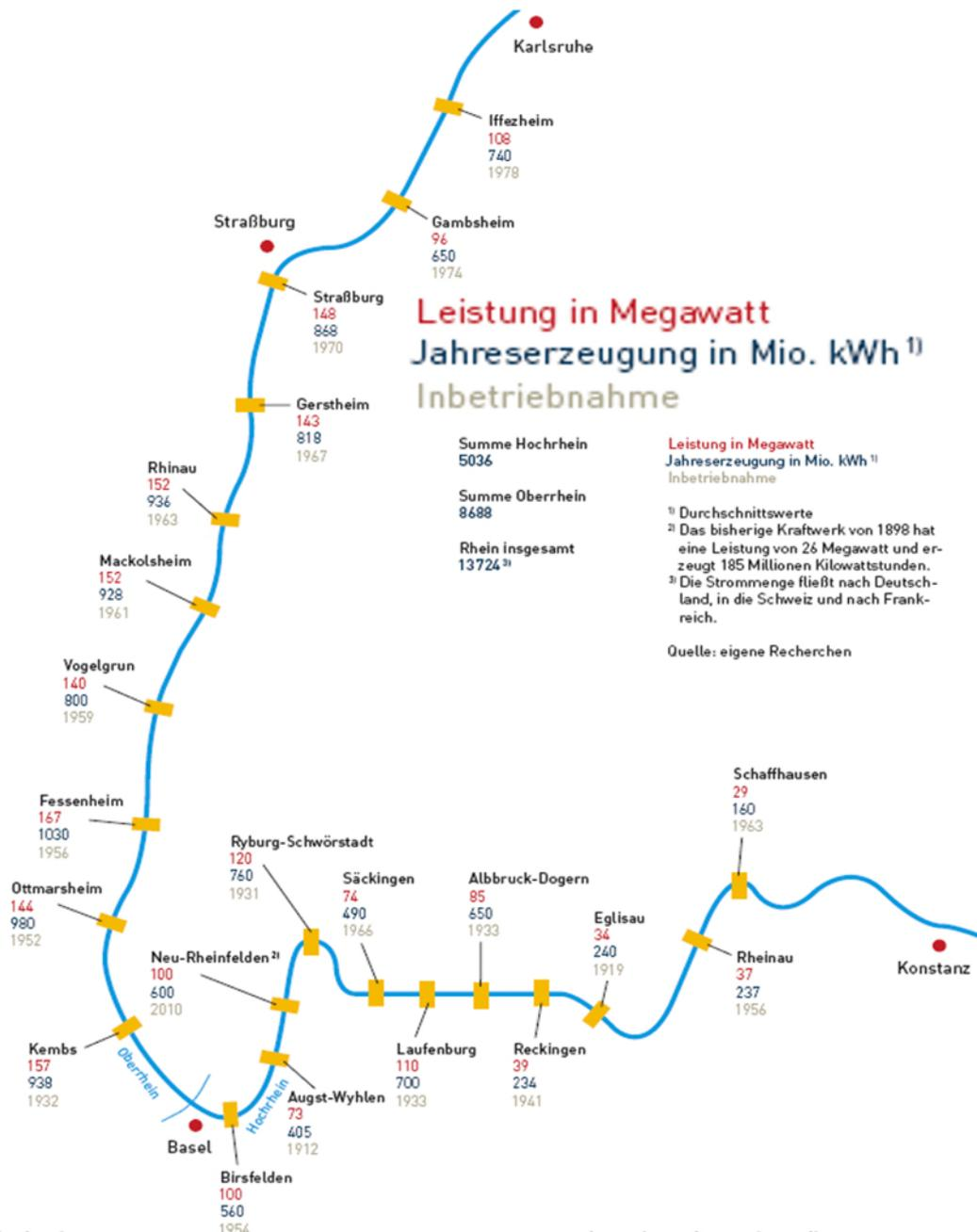
Abb. 38: Ausbau des Flussystems Hoch- und Oberrhein mit Wasserkraftanlagen. Quelle: Neue Energie, Ausgabe Okt. 2010
